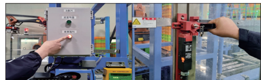
5 작업자 감지 시 로봇 자동 정지 로봇 작업 중 작업자 충돌 방지
